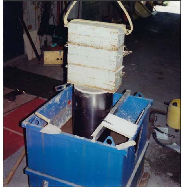
Kuva 2. Savikolle hatuilla varustettujen paalujen varaan perustetun täytetyn terässylinterin vertikaalikuormituskoe.
