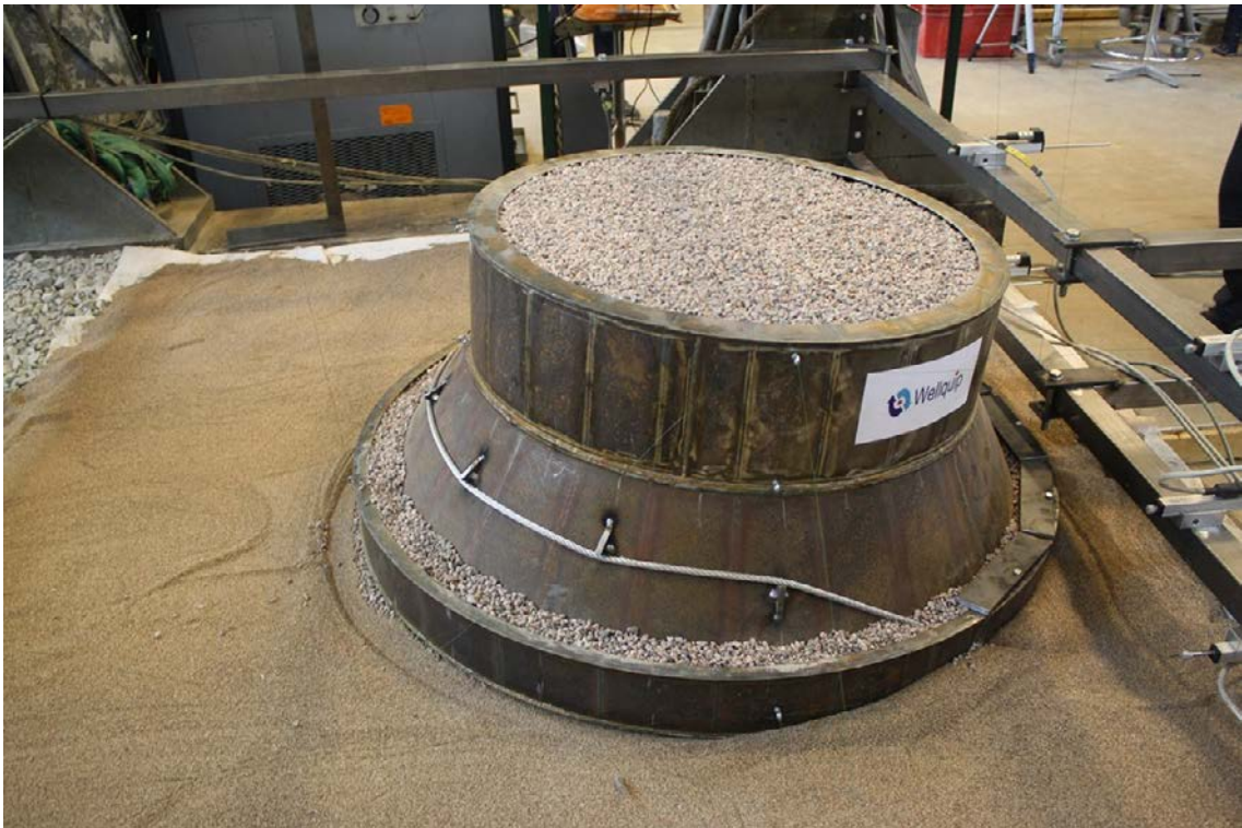
Paaluttamattomien ja paalutettujen teräskuoritasanteiden käyttäytymistä tutkittiin pienoismallikokeiden ja FEM-analyysien avulla Tampereen Teknisessä Yliopistossa. Asiakkaana oli Wellquip.
