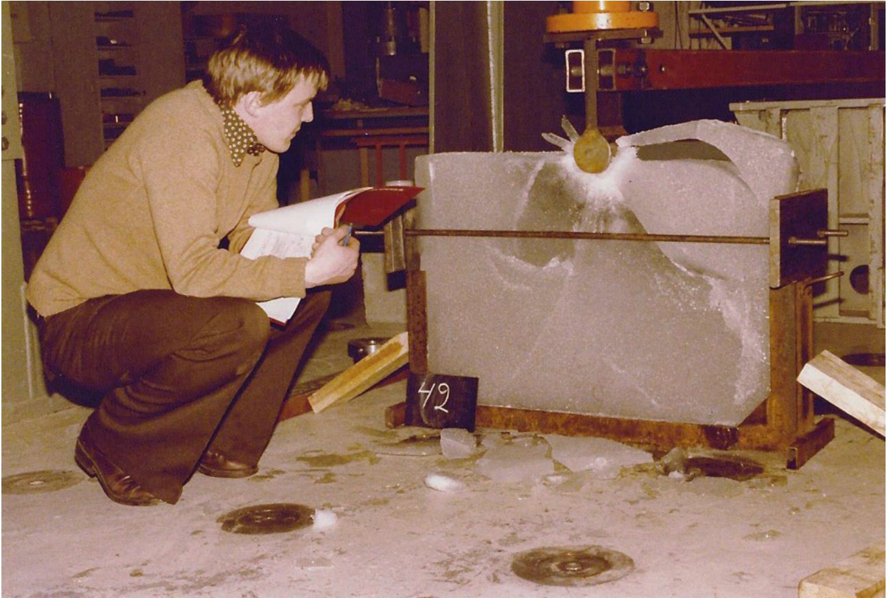
Jään kuormituskokeita TKK:n rakennetekniikan laboratoriossa vuonna 1978.
