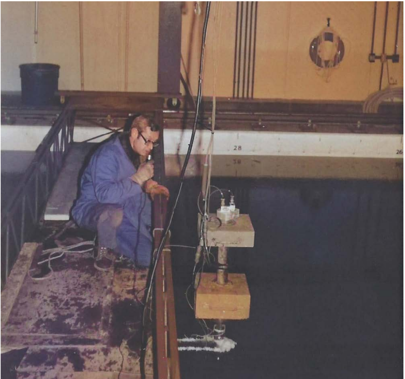
Jään ja rakenteen dynaamista vuorovaikutusta mittaava mallikoe CRELL:in jäätankissa. Kuvassa laboratorioinsinööri Don Haynes.
