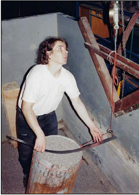
Kuva 1. Maan varassa lepäävää kiviaineksella täytettyä terässylinteriä kaadetaan.
